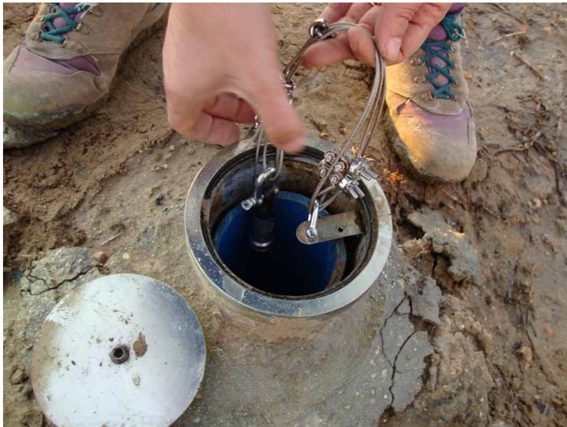
Figura 4.1. Montaje realizado para sujetar los sensores.
