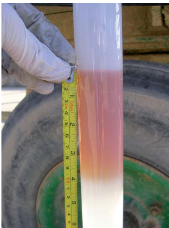
■ FIGURA 5.3.23 FASE LIBRE DE HIDROCARBURO EN EL PIEZÓMETRO 251050050 EN LA CAMPAÑA DE ENERO. ZONA 049-03
