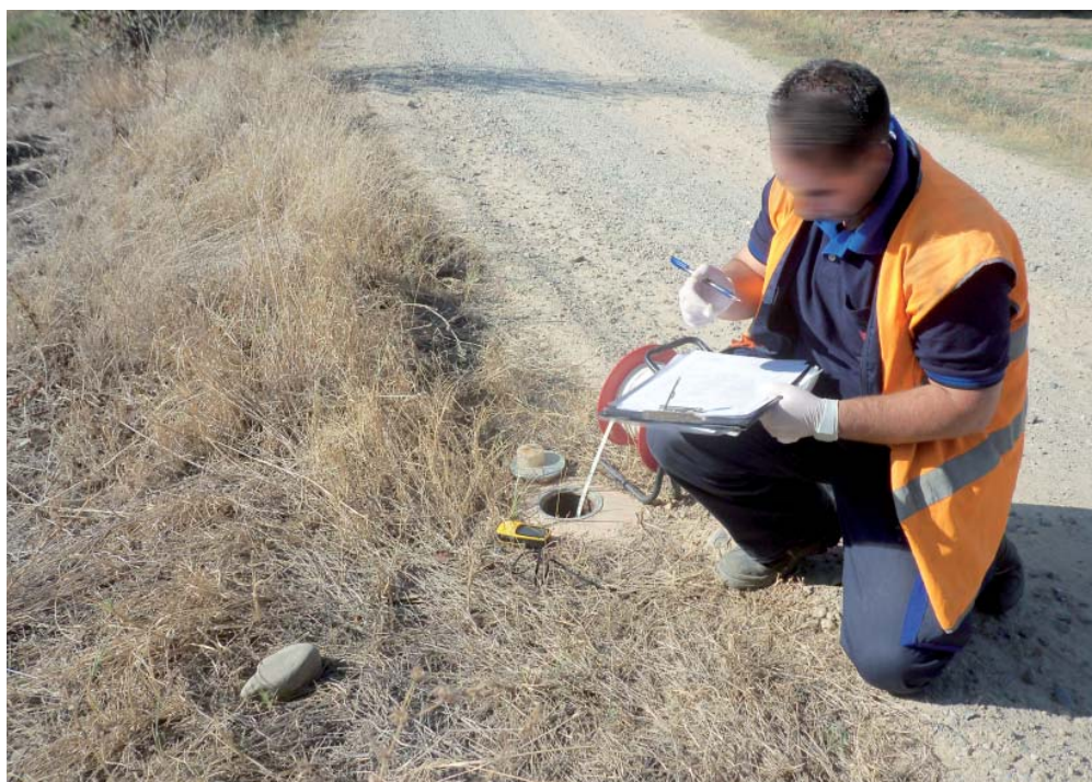
■ FIGURA 5.3.19 MEDIDA DE NIVEL PIEZOMÉTRICO DURANTE LA CAMPAÑA DE OCTUBRE (SONDEO 241060062). ZONA 049-01
