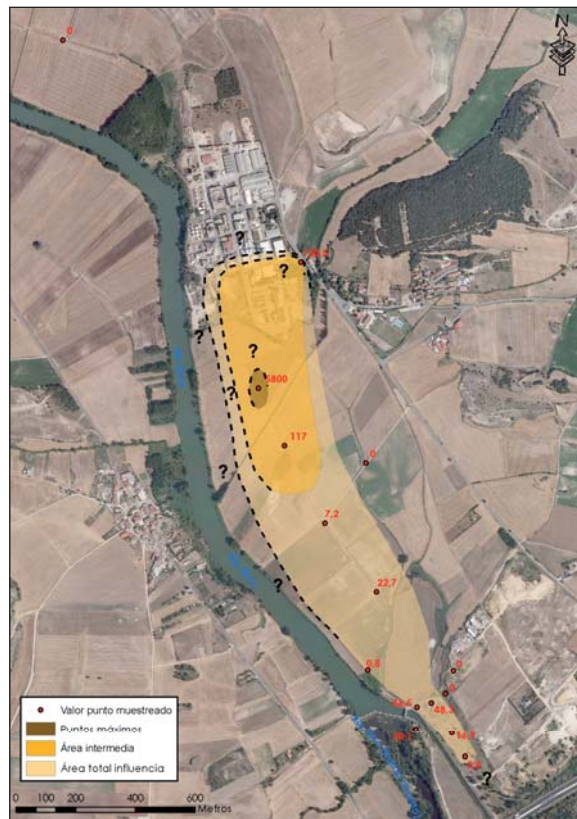
■ FIGURA 5.3.5 ÁREA DE INFLUENCIA DEL BENZOTIAZOL EN LA ZONA 009-01 EL AÑO 2011 (VALOR DE CONCENTRACIÓN EN µg/l)
