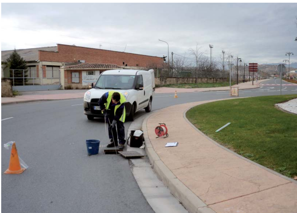
■ FIGURA 5.3.17 MUESTREO DEL PIEZÓMETRO 231010145 DURANTE LA CAMPAÑA DE DICIEMBRE. ZONA 048-02
