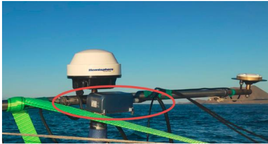
Figura 16. Sensor de movimiento y GPS integrado en el soporte de la ecosonda multihaz.
