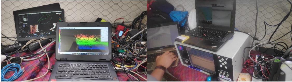
Figura 32 Ordenador de control de navegación con pantalla del operador instalado a bordo. Batimetría + LIDAR (izda) y sísmica (dcha).
