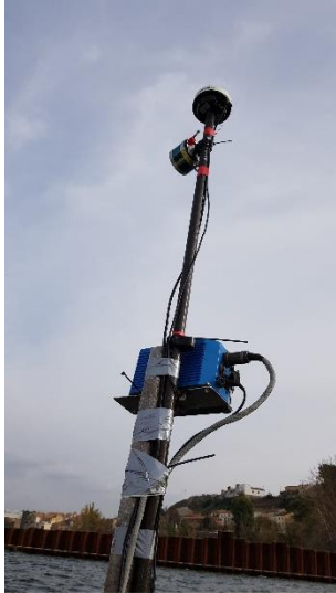
Figura 38 Velodyne VLP16 integrado en el mástil junto a la ecosonda y al sistema MRU+GPS RTK.
