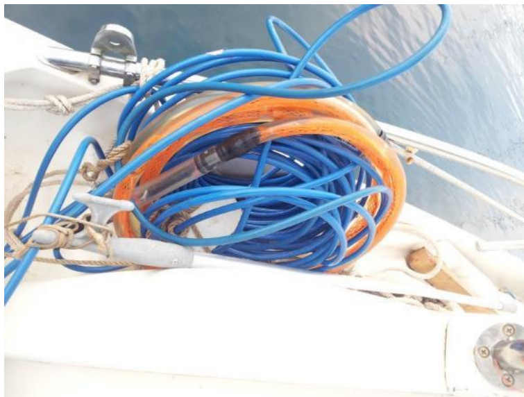
Figura 43. Hidrófono receptor acústico o Streamer
