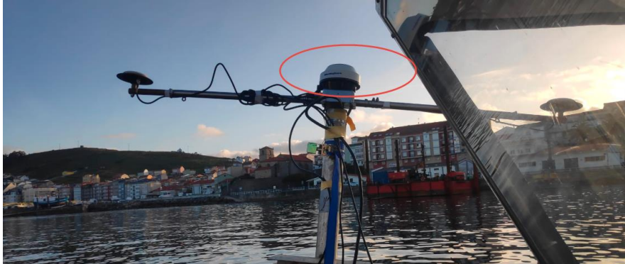
Figura 28 Embarcación con el mástil dónde se instala la antena GPS Rover
