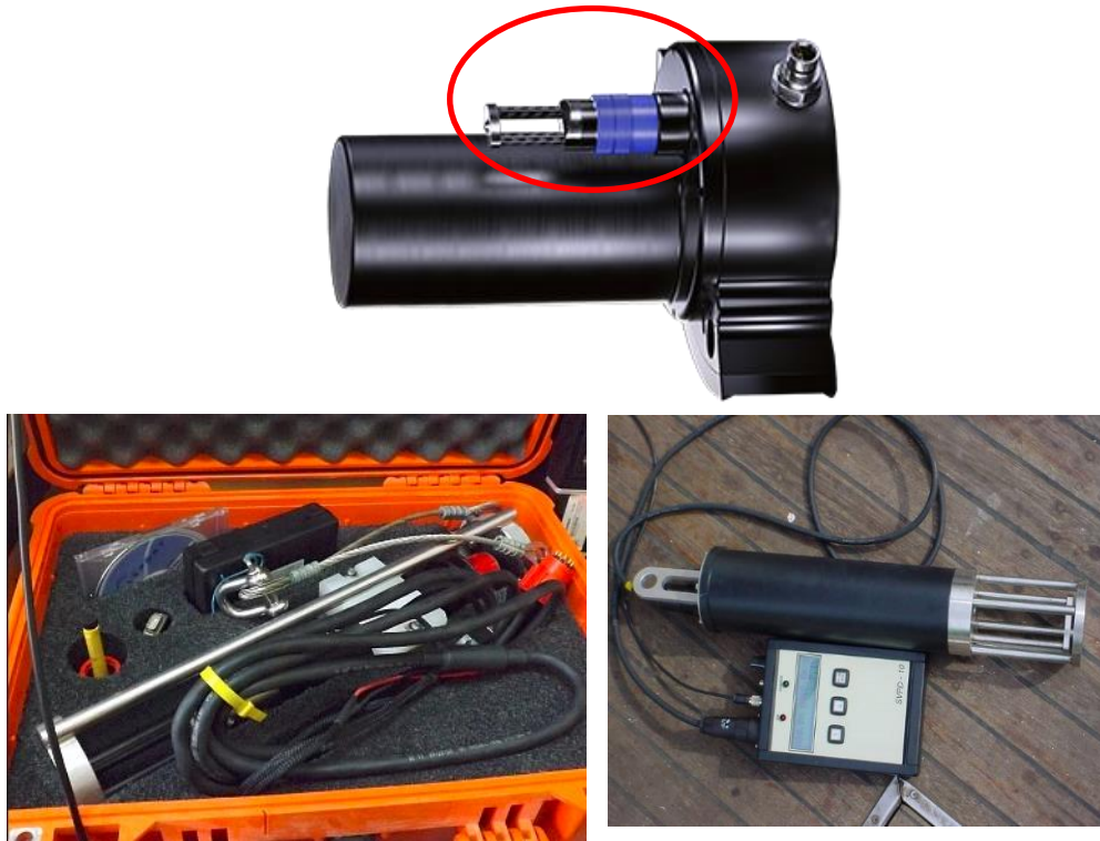
Figura 36 Sensor de la velocidad del sonido en superficie (arriba). Sensor de velocidad del sonido en la columna de agua (abajo.).
