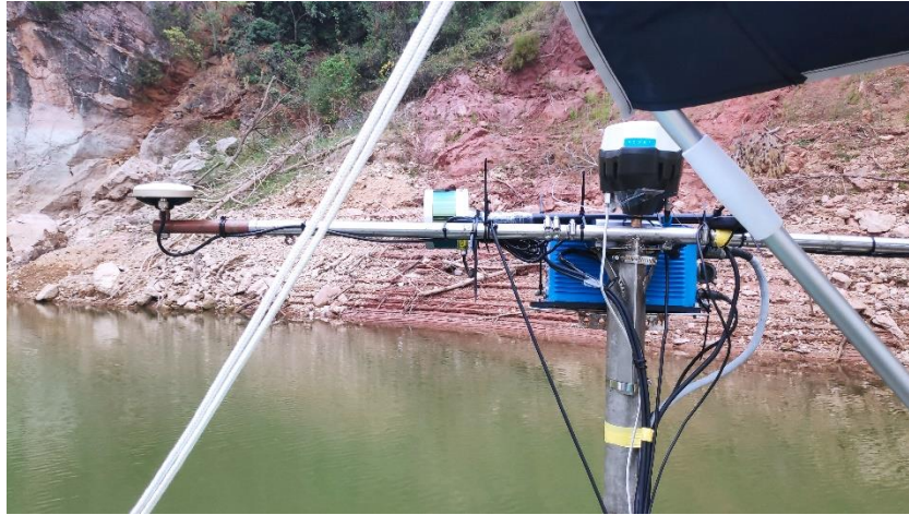
Figura 61 Equipos topo-batimétricos instalados en la embarcación.
