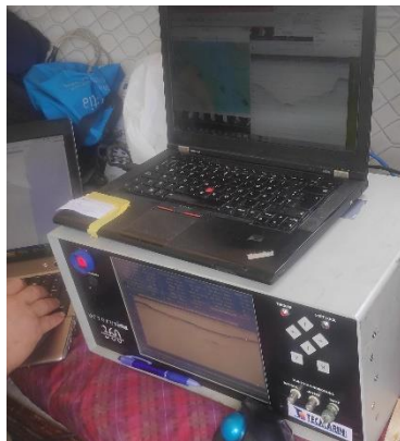
Figura 62 Sistema de adquisición y navegación durante el levantamiento sísmico.
