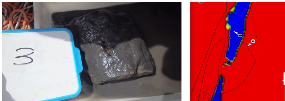
Figura 114 Muestra 3 con mayor contenido de arena y que el sistema clasifica con la clase 3 (rojo).
