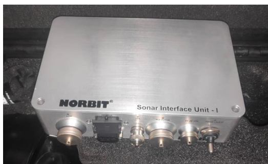
Figura 35 Unidad de cubierta SIU (Sonar Interface Unit)
